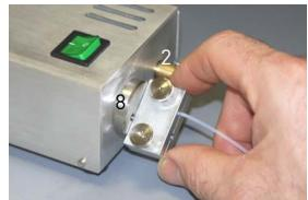
**Achtung: Verbrennungsgefahr an der heißen Flanschspitze (2)!**
