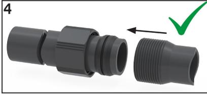
Verbindungsstück auf Rohr stecken / *Put connector on pipe*
