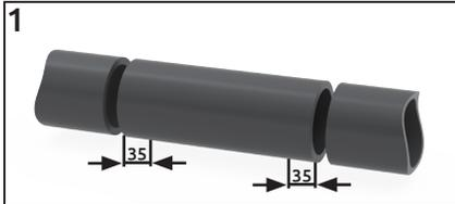
Rohr zuschneiden / *cut the pipe*
