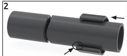
Mutter auf Rohr schieben, Einbaulage beachten / *Put the nut on the pipe, note the mounting position*
