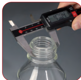
Gewindemessung an einer Flasche
