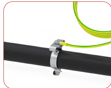
Erdungskabel (Artikelnr. R 612-01) mit zweimal Ringkabelschuh mit Schraube, Mutter und Unterlegscheibe zur Verbindung an Erde mittels z. B. Erdungsglasche wie an b.safe Trichtern.
