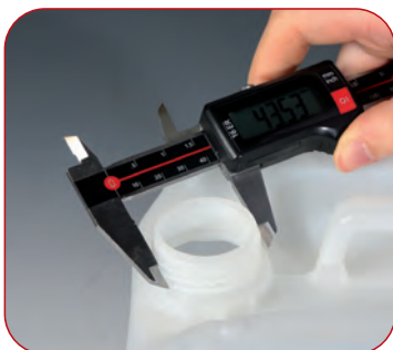
Gewindemessung an einem Kanister
